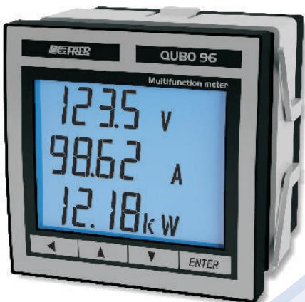
Analizzatore multifunzione per l'impiego in sistemi a corrente continua. L'ingresso di tensione è direttamente collegato alla linea, mentre l'ingresso proporzionale alla corrente viene derivato da shunt. Mediante un semplice menu di programmazione è possibile impostare il valore della corrente primaria. L'ampia gamma di shunt FRER è visibile sul catalogo generale (Sezione 11) oppure on-line www.frer.it
