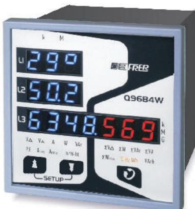
Analizzatore multifunzione adatto per l'impiego in sistemi trifase a tre o quattro fili con carico squilibrato, anche in presenza di forme d'onda distorte. Permette la visualizzazione di tutte le principali grandezze caratteristiche di una rete elettrica (16 grandezze, 32 misure) su un unico strumento, riducendo notevolmente la complessità ed i costi di installazione.
