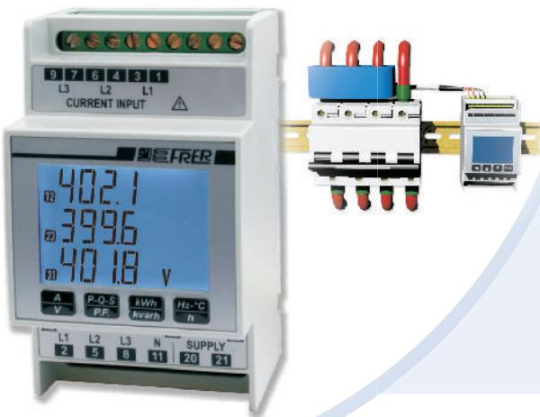
Analizzatore multifunzione compatto per l'impiego in sistemi trifase a tre o quattro fili con carico squilibrato. Permette la visualizzazione delle principali grandezze di una rete elettrica, inclusi i conteggi di energia attiva e reattiva.
