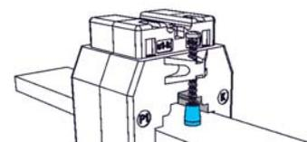
Cappuccio di protezione per vite fissaggio cod. 9SAMCP
