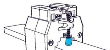
Cappuccio di protezione per vite fissaggio cod. 95AMCP
