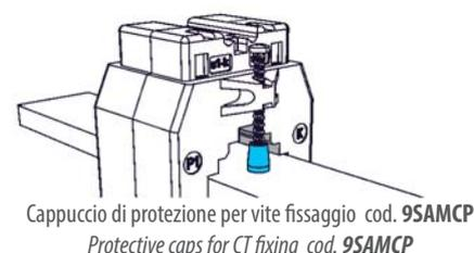
Cappuccio di protezione per vite fissaggio cod. 9SAMCP
