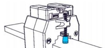
Cappuccio di protezione per vite fissaggio cod. 9SAMCP
