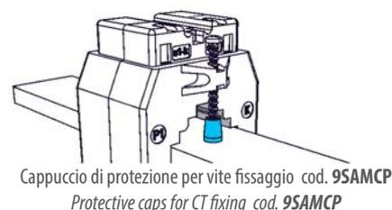
Cappuccio di protezione per viti fissaggio cod. 9SAMCP
